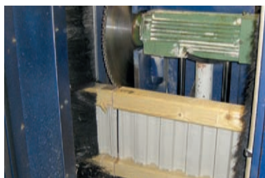
Découpe sur-mesure en sortie de presse
